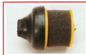
Art. 20128 Gruppo filtro per pista Tarmac air filter Glattbahn Luftfilter Filtre pour piste
